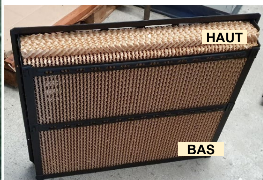
Echangeur fixé sur le panneau latéral
