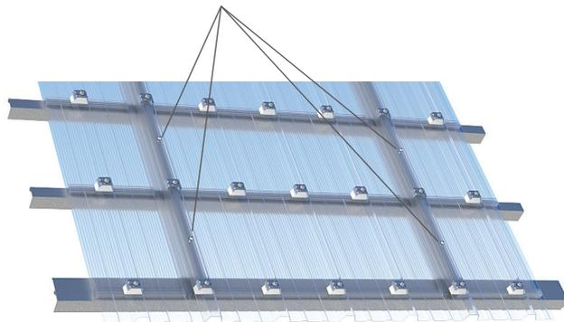
Recouvrement longitudinal panneau sandwich
