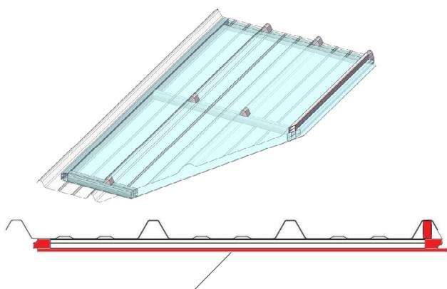
L'option Confort Thermique (T) comprend une sous-face en polycarbonate alvéolaire 16mm.
