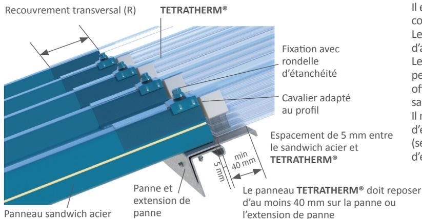
Il est essentiel que les deux panneaux reposent correctement sur la panne (ou l'extension de panne). Le panneau TETRATHERM® doit reposer d'au moins 40 mm sur la panne. Les fixations principales doivent passer à travers la peau supérieure du panneau TETRATHERM® qui fait office de recouvrement, ainsi que dans le panneau sandwich acier. Il ne faut pas oublier d'installer les compléments d'étanchéité qui ne sont pas présents sur l'illustration (se référer au paragraphe «Compléments d'étanchéité»).
