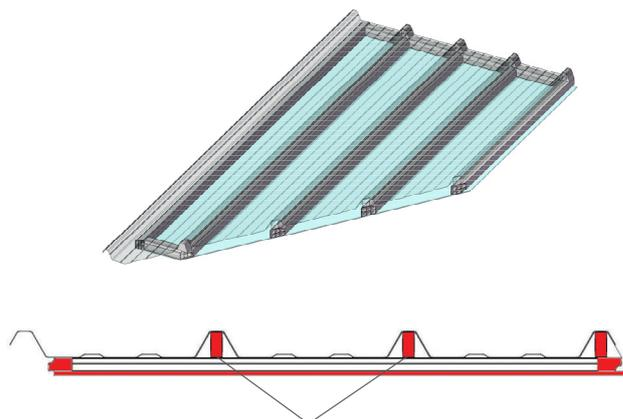
Les options Confort Thermique et Renforcé (TR) combinent l'ajout de renforts longitudinaux en polycarbonate sous chaque nervure avec l'utilisation d'une sous-face en polycarbonate alvéolaire 16 mm.
