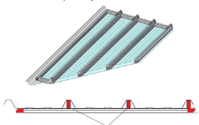
**A :** Renfort longitudinal en polycarbonate sur toute la longueur de la nervure recouverte.
