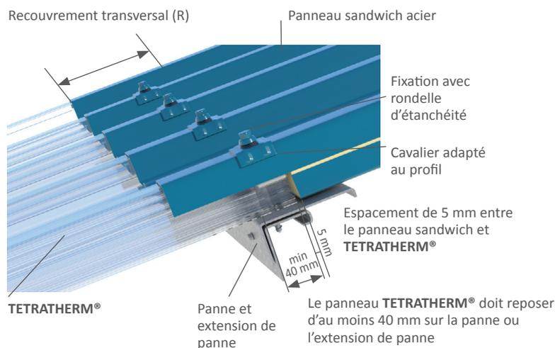
Il est essentiel que les deux panneaux reposent correctement sur la panne (ou l'extension de panne). Le panneau **TETRATHERM®** doit reposer d'au moins 40 mm sur la panne.
