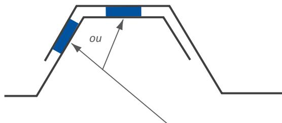
Complément d'étanchéité au recouvrement longitudinal
