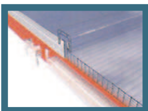
4. Mise en place des obturateurs en extrémité des panneaux
